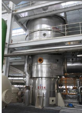
› Design bem dimensionado e eficiente que permite o uso de toda a energia térmica. Seu Stripper permite atingir baixos níveis de Hexano bruto. Configuração compacta que economiza o tamanho do prédio.
