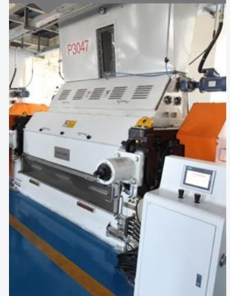
› Equipamento construído com alimentador, destorrador, sistemas de limpeza e raspadores. Rolos e componentes europeus dos principais fabricantes do mundo fazem deste laminador o de maior fluxo no mercado.
